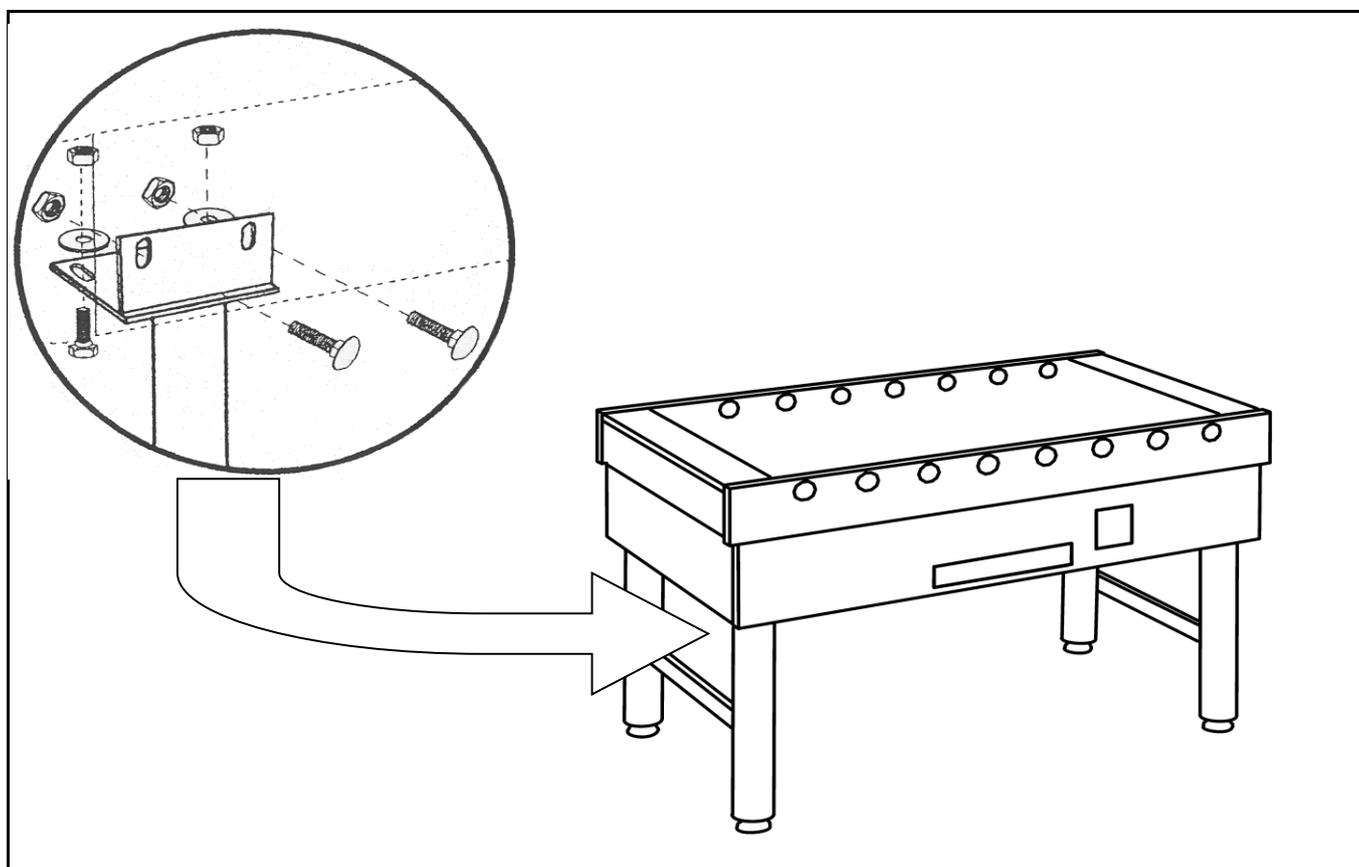
**Fissaggio delle Aste – Fitting The Poles**
